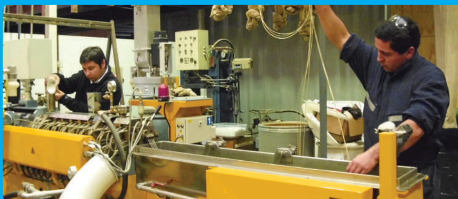
Extrusora para la obtención de pellets, Labtech Engineering, modelo LTE26 – 40. Compuesta por un equipo extrusor doble tornillo de 26 mm. de diámetro y 40L/D.
